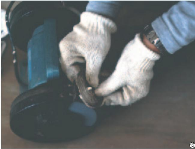
⑬ 鏡面(モノが映る面)の大きな凹凸もグラインダーで削り取り、なるべく平らになるようにします。
