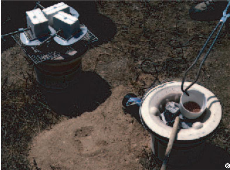
⑥ 鑄造炉のかわりに七輪を使います。中に木炭を入れ、炭火をつくり、通風口から風を送り込んで燃焼温度を上げていきます。当時は風を送る装置としてフィゴを使っていましたが、今回はドライヤーで代用します。また鑄型は二つを合せてクランプで留め、湯を流し込む時、高温で鑄型が急激に膨張して割れてしまうのを防ぐため、あらかじめ温めておきます。
