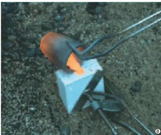
⑧ 銅が十分に溶け、湯が出来上がると、るつぼさみでるつぼを持ち上げ、鑄型に流し込みます。流し込む時の手際の良さが仕上がりに影響しますので注意してください。
