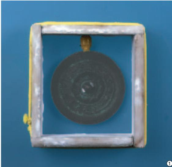
① かまぼこ板などで型枠をつくり、その中に原型となる鏡(ここでは中国前漢鏡のレプリカ)を置きます。そして湯を流し込むところである湯口(写真上側の黄色テープ)を設置します。
