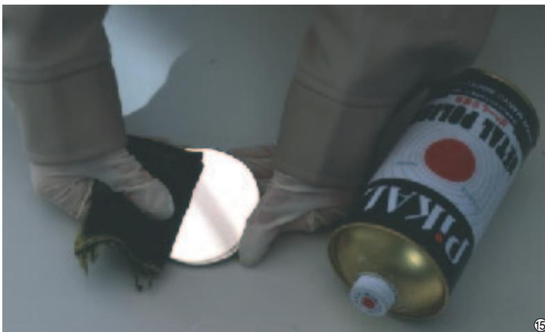
⑮ 「ピカール」などの金属研磨剤を使って最後の仕上げに入ります。まず雑巾などに研磨剤を付けて磨き上げ、最後にメガネ拭き用の布などを使っていねいに磨き上げると、びっくりするほどの光沢と鏡本来の反射光が現れます。
